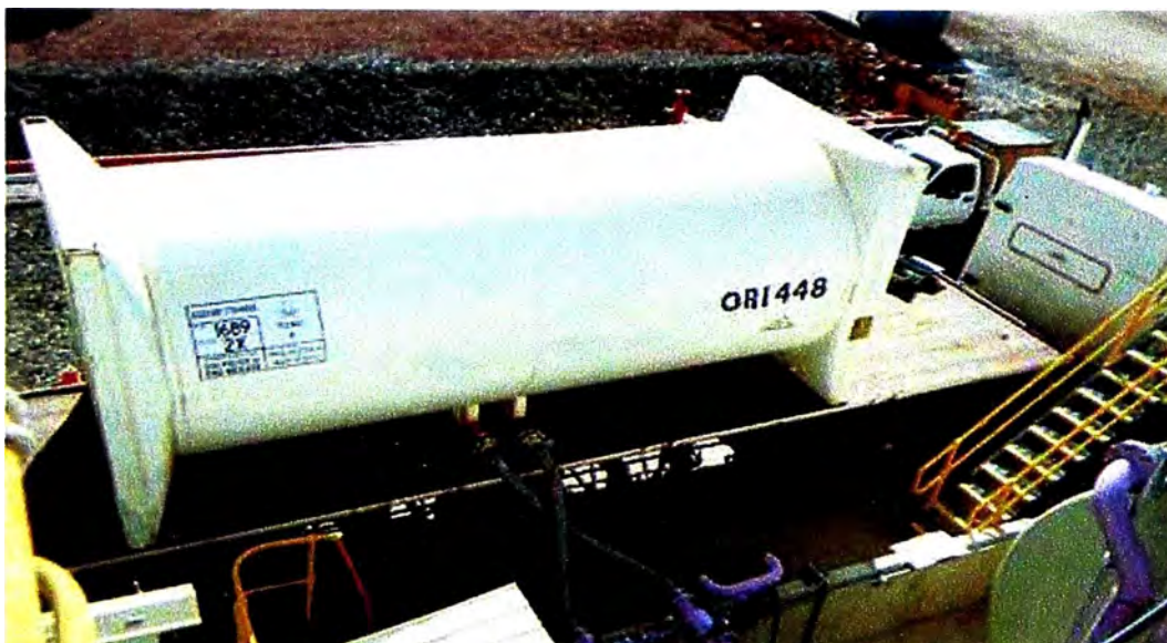
Fig.6.2. Camión e Isotank para el transporte de Cianuro de Sodio Esparcido
