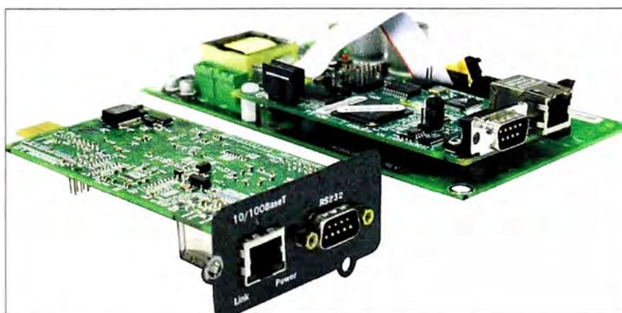
**Figura 2.4 Tarjeta de red utilizada en los equipos Liebert**
