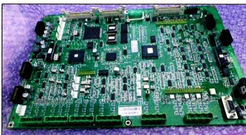
**Figura 2.3 Tarjeta de Control del UPS General Electric modelo LP33**
