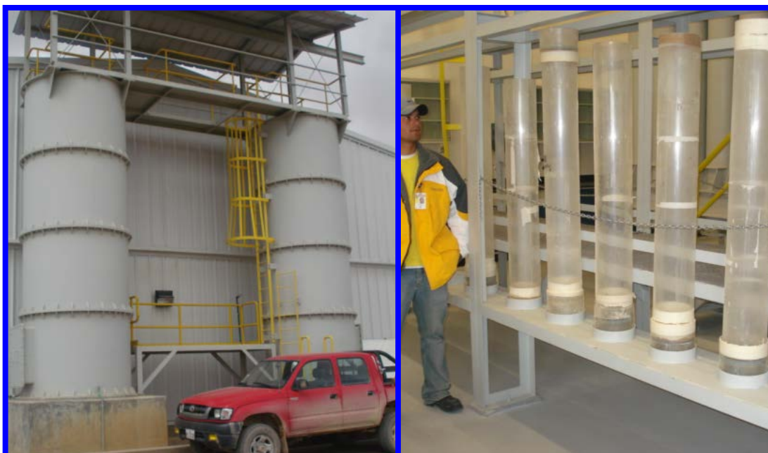
Figura 33. Columnas de 2m y 15.24cm (6") de diámetro en el Laboratorio Metalúrgico de Minera Yanacocha S.R.L.
