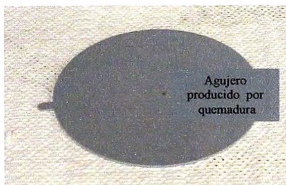
Fig. VII.5 Espécimen después de ocurrida la interrupción dieléctrica
