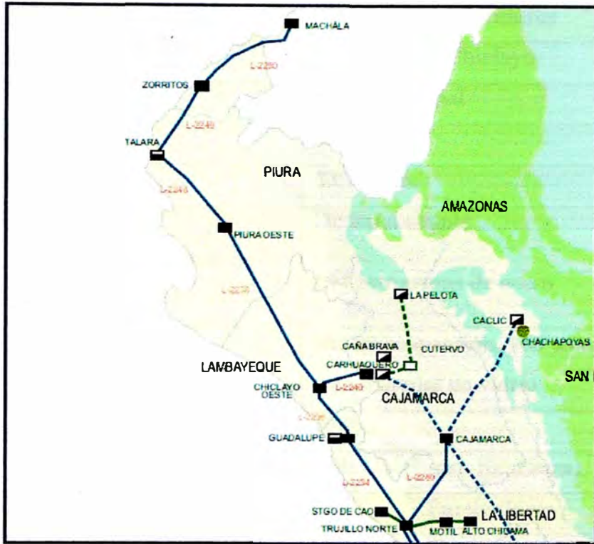
Figura 2.1.: Sistema de transmisión del área norte del Perú
