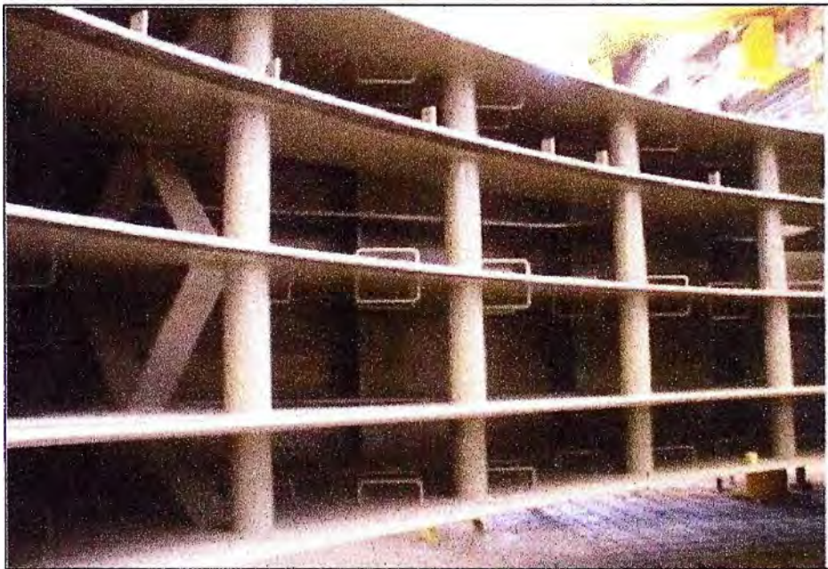
Fig. 2.3: Carcaza de estator
