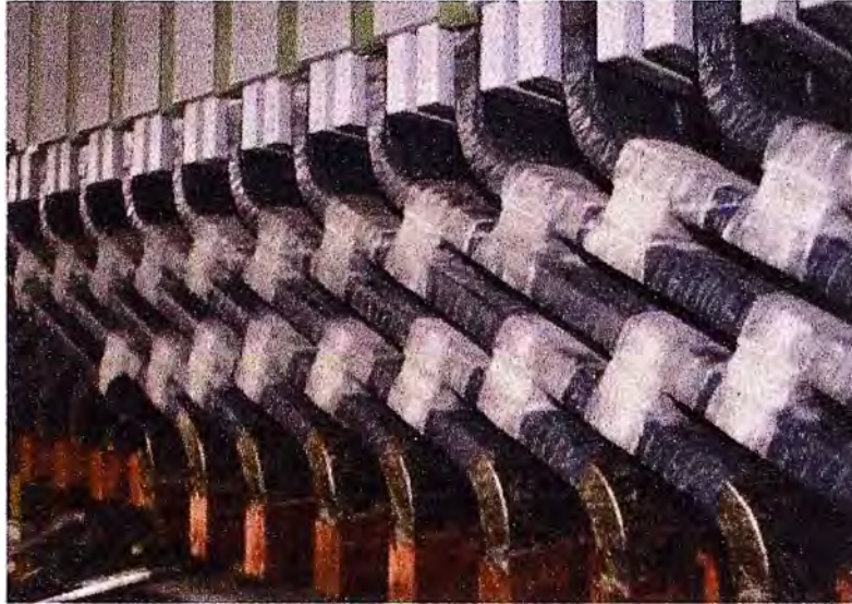
Fig. 2.4: Bobinado del estator
