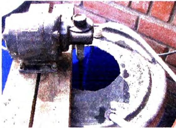
Fig.10.1 Motor para la Agitación del Sustrato
