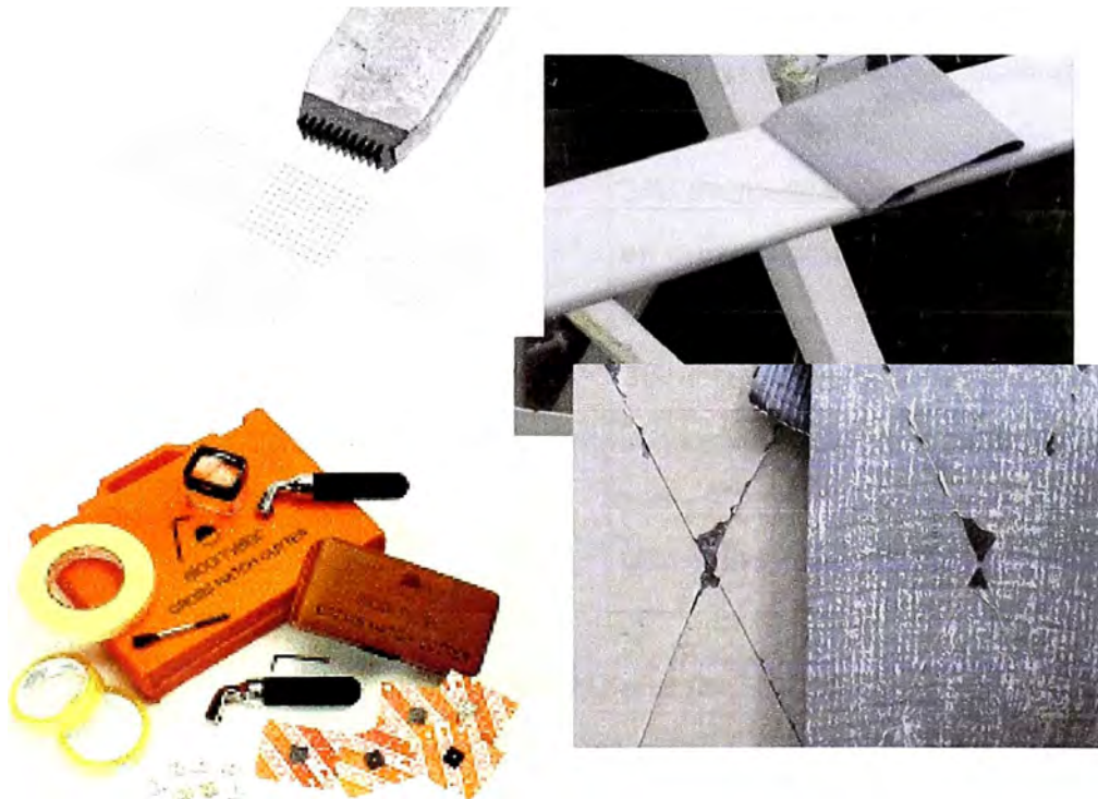
Figura N° 17.- Medidores de Adherencia en Campo
