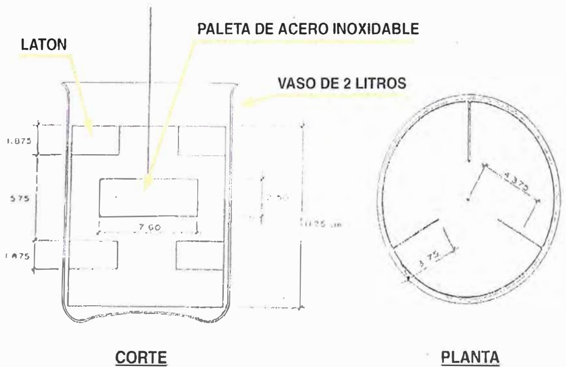
FIGURA N° 2.6: DETALLE DEL DEFLECTOR
