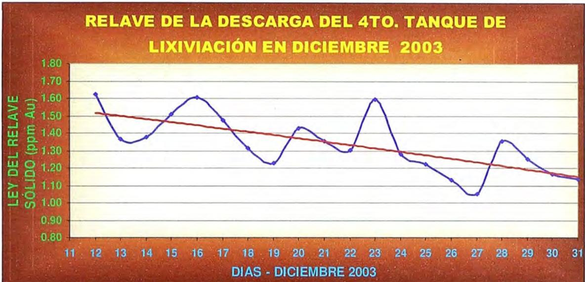
Gráfico N° 2: Descenso de la ley de oro en el sólido del Relave de la Descarga del 4to. Tanque. Se observa que al aumentar el oxígeno libre disuelto en los tanques de lixiviación, la ley de oro del sólido del relave en la descarga del 4to. tanque de lixiviación disminuye hasta 1.14 gr. – Au / tms de relave seco. Se observa el gráfico N° 3:
