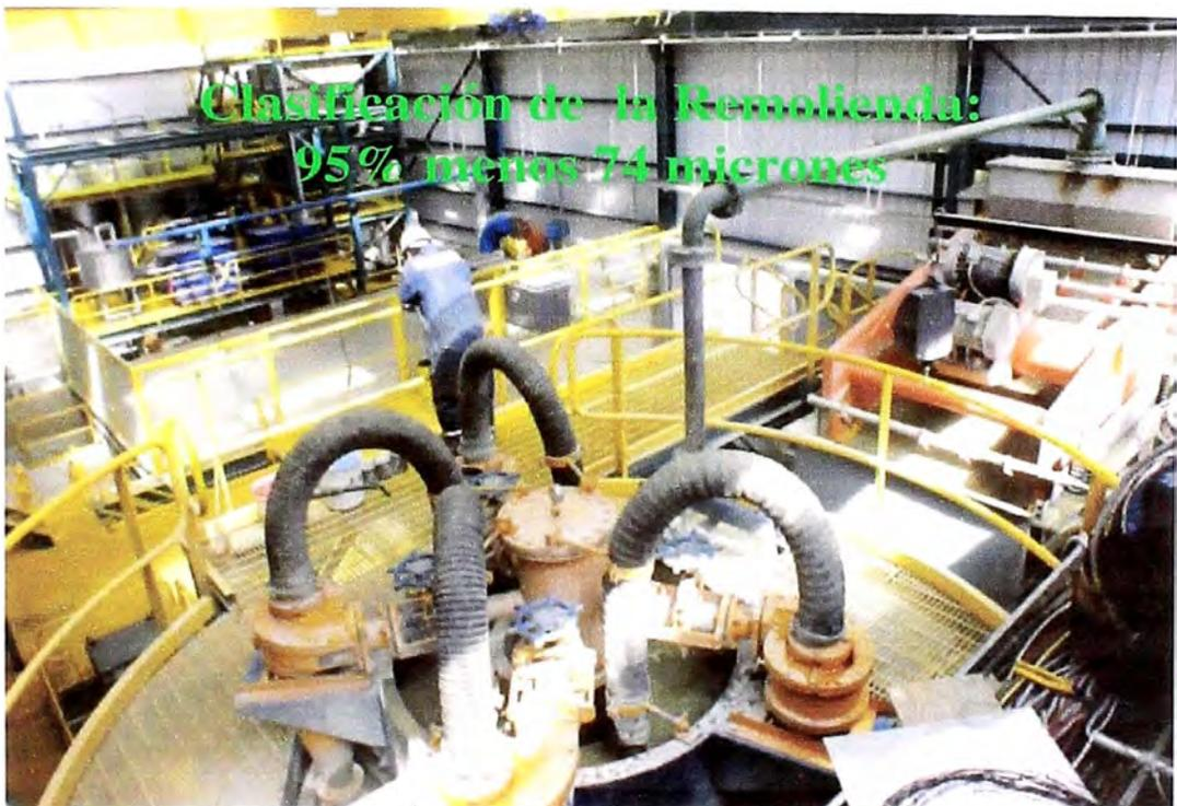
Fotografía N° 3: Se observa la Clasificación y alimento a los Concentradores (derecha)
