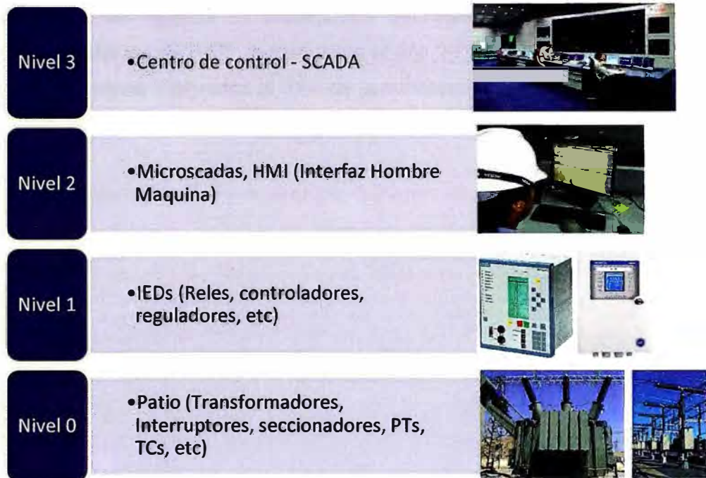
Fig. 2.22 Niveles de automatización de una subestación
