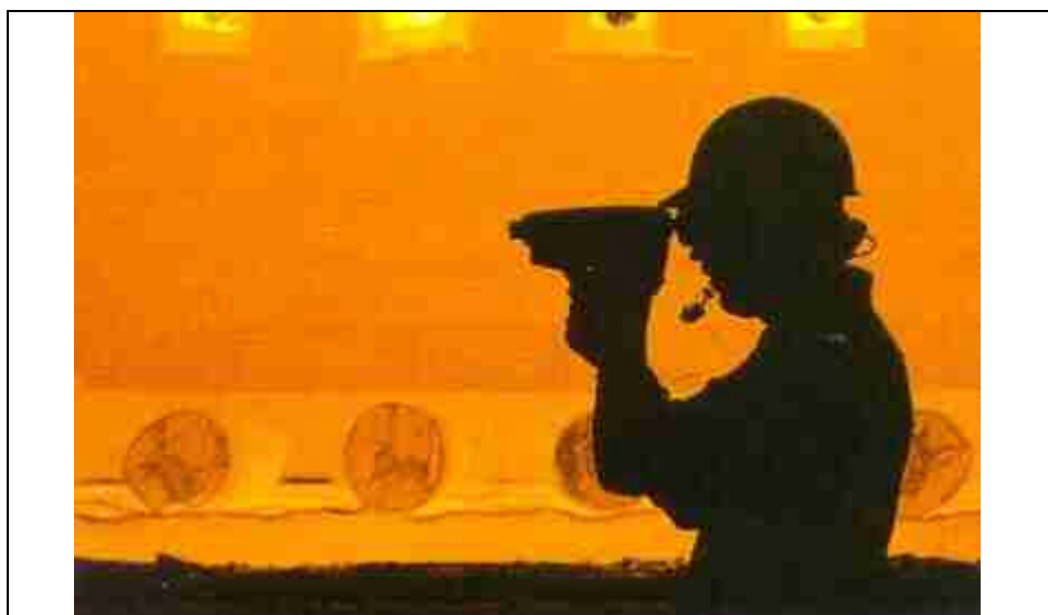
Figura 4.- Medición de altas temperaturas - termómetro de radiación o pirómetro
