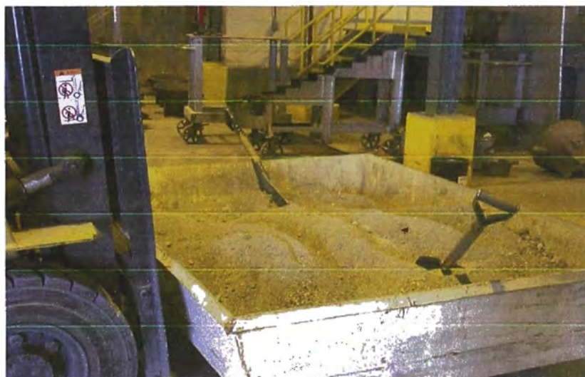
Figura 3.8 Foto de una bandeja conteniendo precipitado húmedo cosechado de los filtros prensa listo para ser retortado en el área de Refinería
