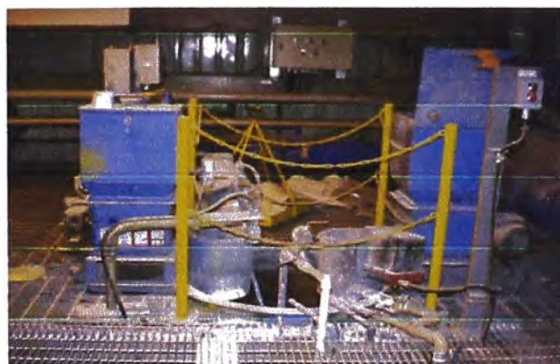
Figura 3.4 Foto del cono de agitación de Zinc presente en la planta de Merrill Crowe
