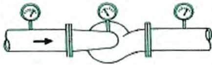
Figura 2.10 Se muestra como en secciones de tubo más angostas se tiene presiones estáticas más bajas
