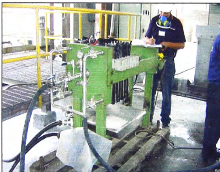
Figura IV.1 Proceso de Filtración Lodos del Espesador E-03
