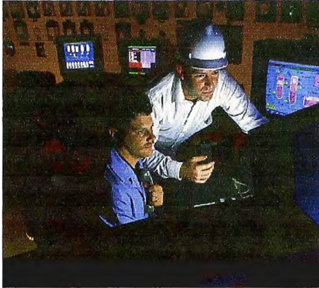
Fig.5.35 Las herramientas SCADA se utilizan en el monitoreo y control de procesos industriales.
