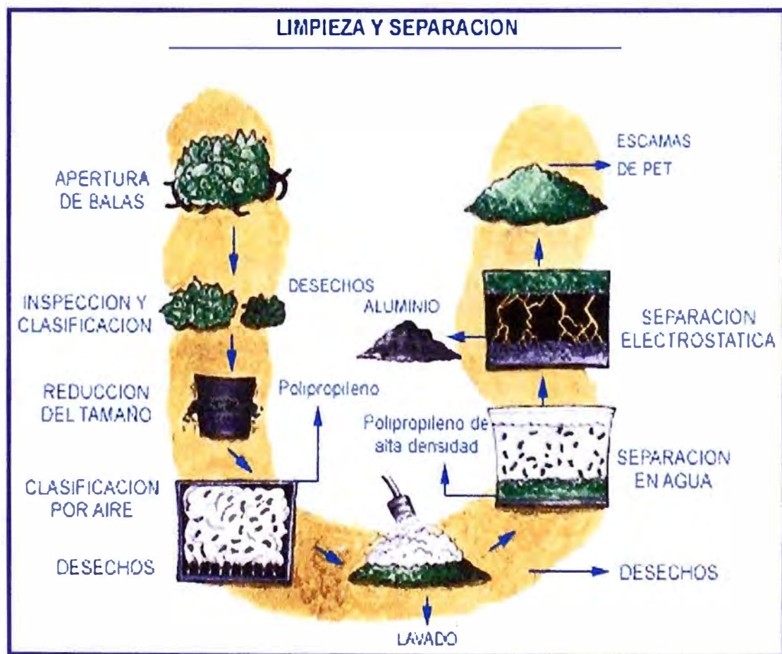
Esquema 1.3.: Limpieza y Separación del Reciclado Mecánico del Pet
