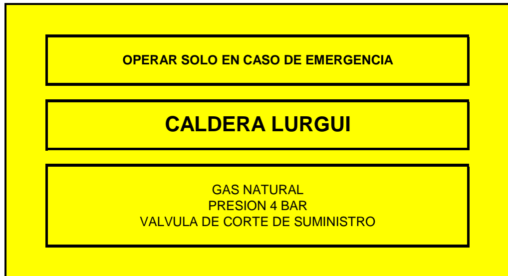
Figura 5.6 Rotulo sugerido para las válvulas de corte de suministro de cada equipo o grupo de equipos
