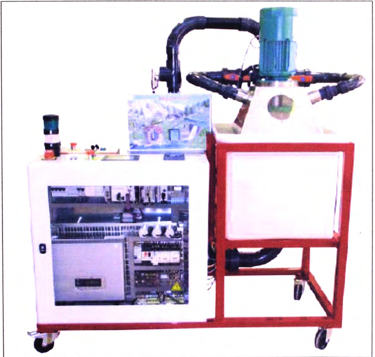
Fig.B.1 Prototipo de planta minihidroeléctrica controlada electrónicamente
