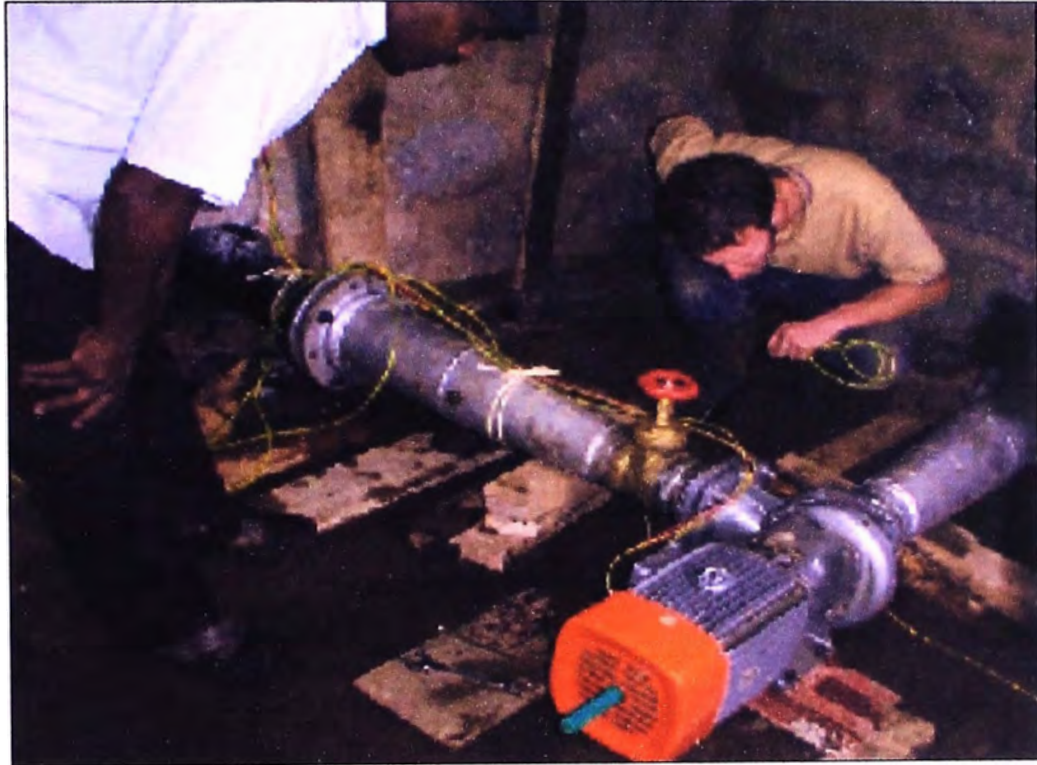
Fig. C.4 Un motor de inducción como generador que produce 2.2kW
