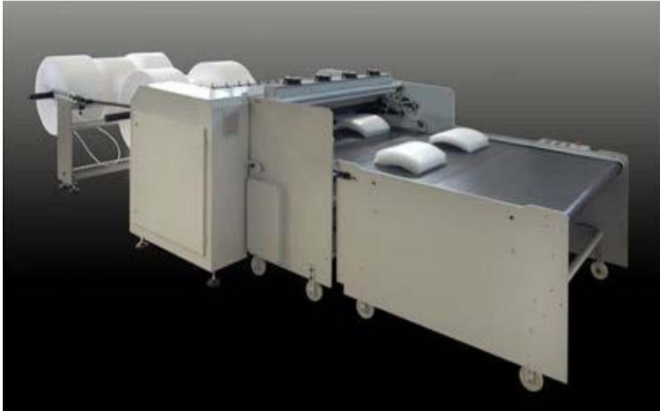
Figura 2.3 Maquina de Corte y Sellado
