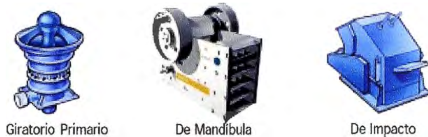
Figura N° 7: Tipos de Chancadoras
