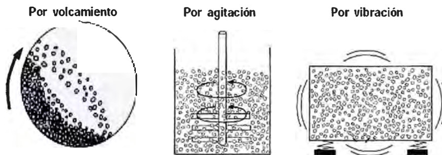
Figura N° 8: Tipos de Molienda
