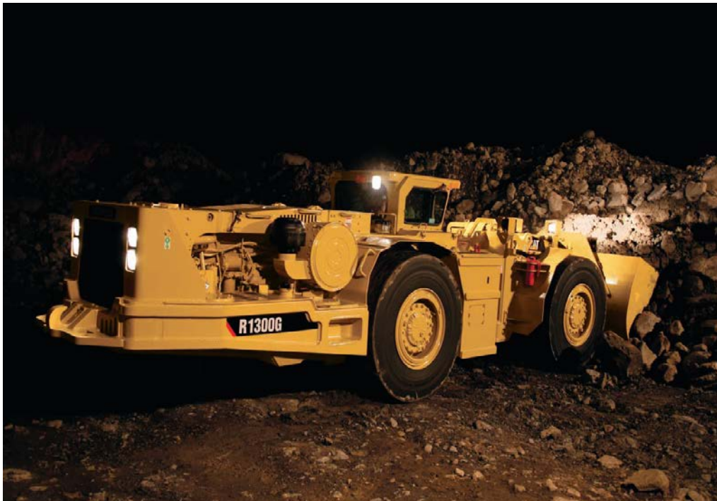
Figura 8.- Equipo Scooptram de 4.1Yd 3
