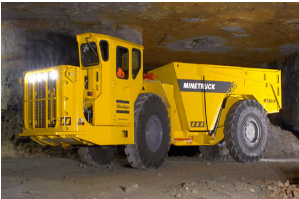
Figura 7.- Equipo dumper de 20TN
