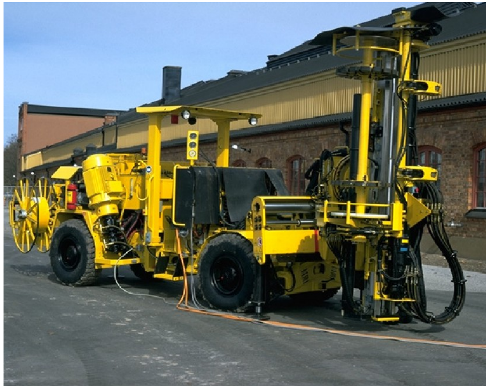
Figura 11: Equipo de Perforación Taladros Largos
