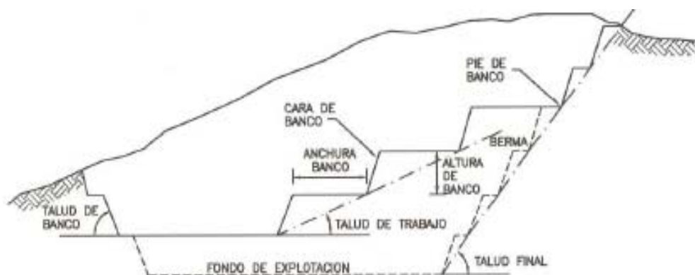
. Figura 4.16 Terminología empleada en una mina a cielo abierto
