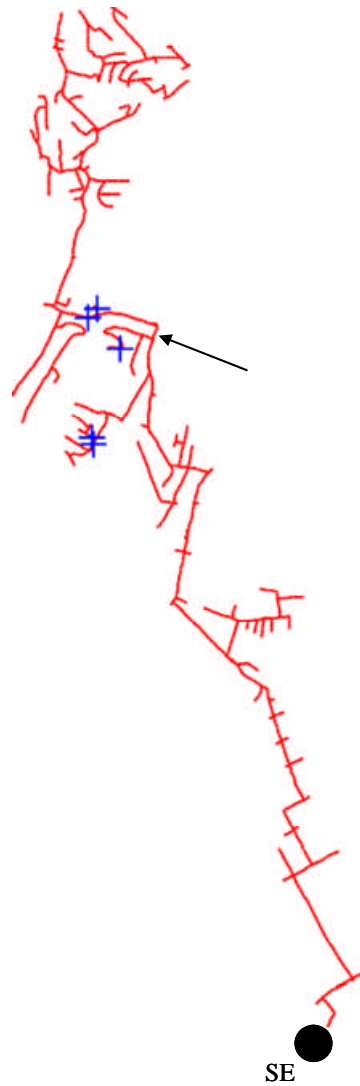
Figura 5.13 Circuito VME 0111, en cruz los puntos localizados por el software e indicado con la flecha el punto real de la falla.
