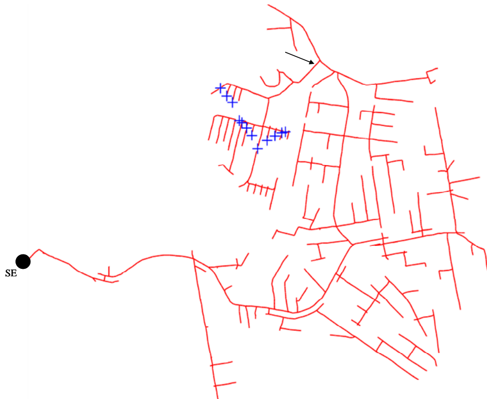
Figura 5.9 Circuito MSA 0110, en cruz los puntos localizados por el software e indicado con la flecha el punto real de la falla.
