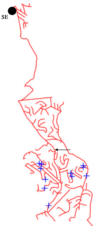
Figura 5.11 Circuito EPE 0102, en cruz los puntos localizados por el software e indicado con la flecha el punto real de la falla.
