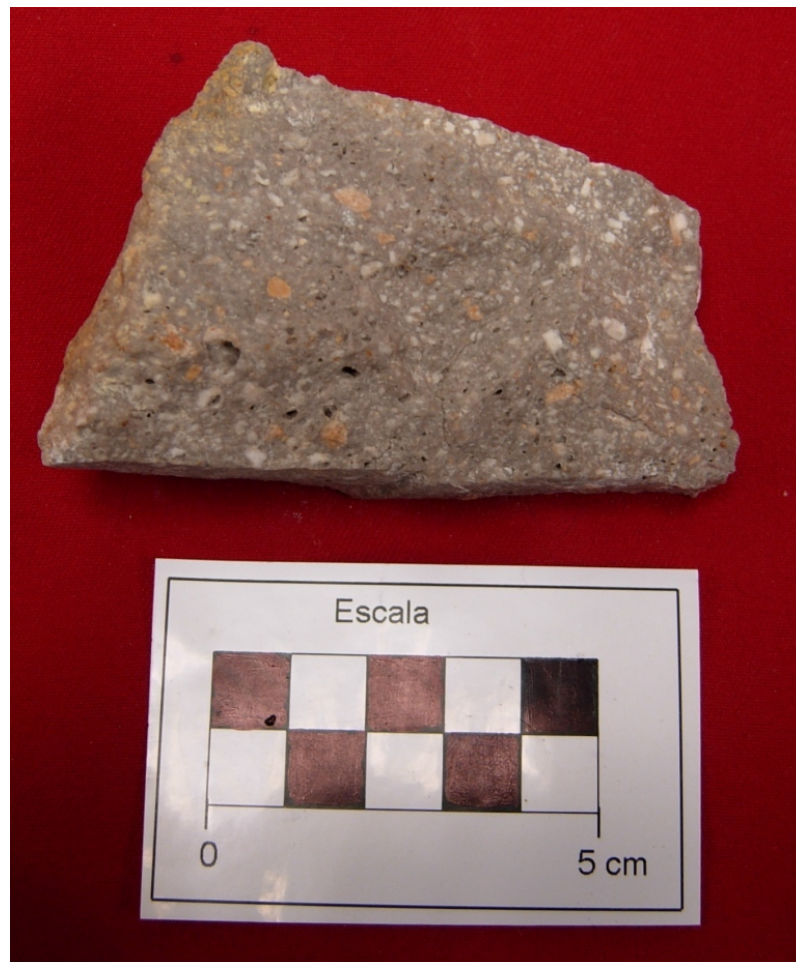
Fig. 21: Dacita porfírica (Yp), de textura porfírica de grano grueso >3mm. Los fenocristales de feldspatos están alterados a arcillas. Las hornblendas reemplazadas por sulfuros (pirita), biotitas alterándose a cloritas y carbonatos. Ensamble clorita – calcita – cuarzo.
