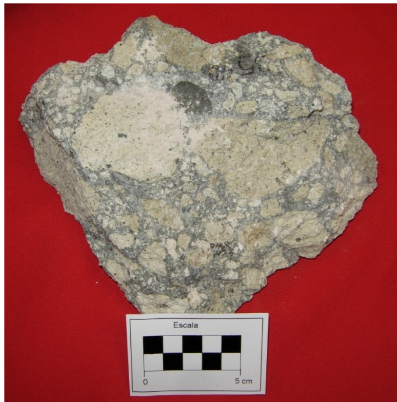
Fig. 6: Muestra de la unidad LA, roca de textura fragmental heterolítica con matriz porfírica, la muestra es característica de un Lahar.
