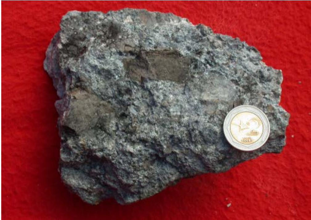
Fig. 25: Brecha freatomagmática, obsérvese la matriz porfirítica con fragmentos heterolíticos, angulares a subredondeados y silicificados. Pirita diseminada. La alteración es argílica.
