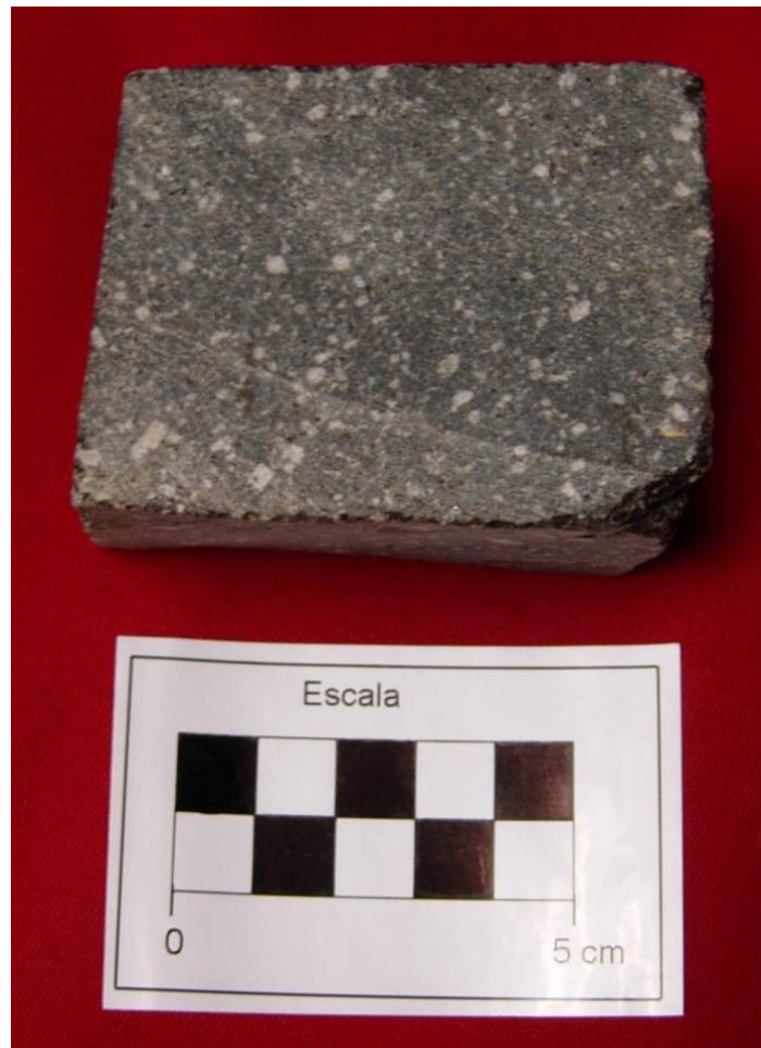
Fig. 10: Muestra de la unidad UphA, andesita de textura porfido afanítica con fenocristales de grano medio, débilmente alterados.
