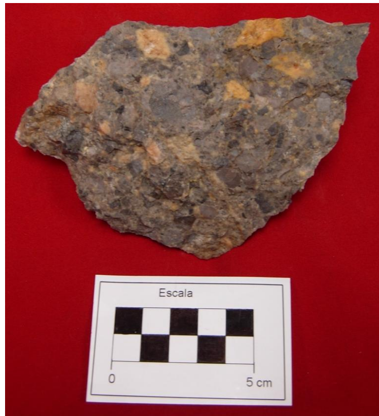
Fig. 29: Brecha Freática, obsérvese la matriz totalmente silicificada con poca presencia de óxidos y los fragmentos líticos subangulosos silicificados.
