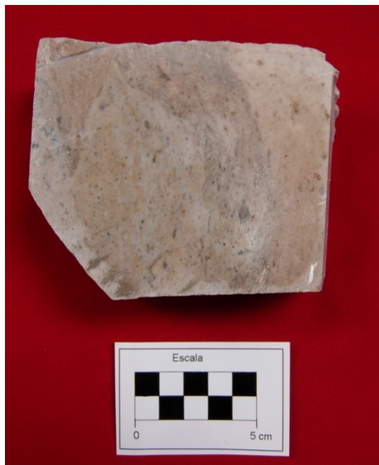
Fig. 7: Muestra de la unidad Tft, conformada de cristales finos alterada a sílice masiva.
