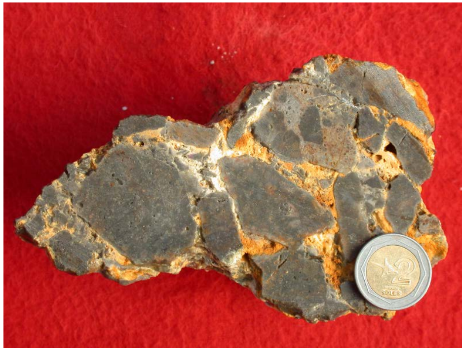
Fig. 28: Brecha Crakel obsérvese ligero movimiento de los clastos posiblemente debido a los fluidos hidrotermales que se movilizaron a través de las fracturas, ahora rellenas de óxidos. Es posible observar clastos silicificados dentro de los fragmentos monolíticos que indica varios eventos de brechamiento. La alteración es argílica avanzada.
