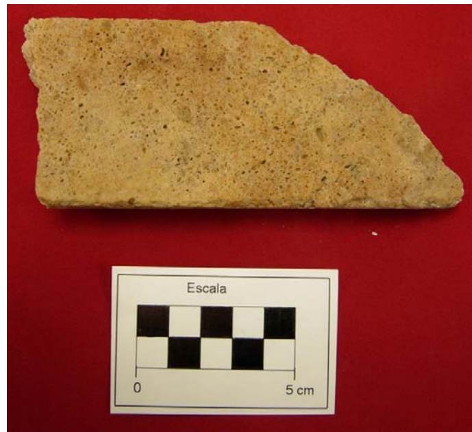
Fig. 19: Tufo de cristales. Los moldes de los cristales están rellenos parcialmente por hematita. La alteración es silice vuggy. Ley 0.992 Au g/t.
