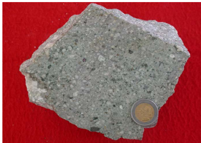
Fig. 23: Tonalita porfirítica (Ypq) de textura porfirítica de grano grueso. Se observa ojos de cuarzo. La pirita se encuentra diseminada y reemplazando a los fenocristales.
