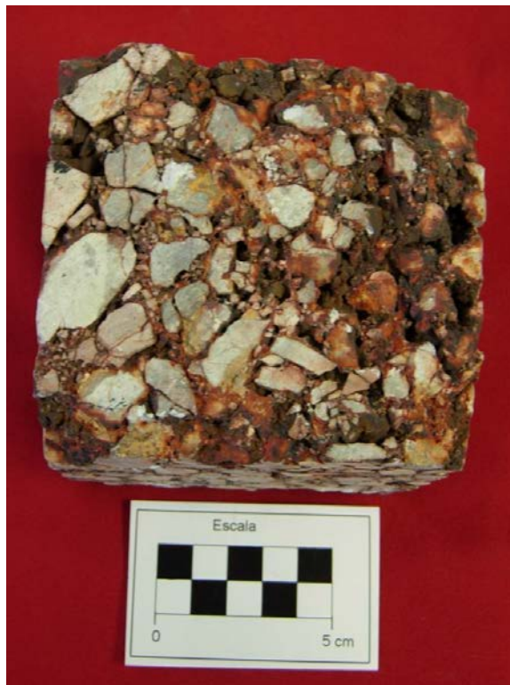
Fig. 27: Brecha Hidrotermal, obsérvese la matriz rellena de óxidos - limonitas, fragmentos heterolíticos, angulares a subredondeados y silicificados. Las paredes de las cavidades están recubiertas por limonitas. La alteración es sílice masiva. Ley: 1.726 Au g/t.
