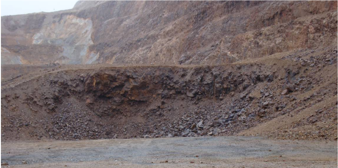
Fig. 26: Frente de brecha hidrotermal muy fracturada, nótese la fuerte oxidación compuesta de gohetita y limonita (foto mirando al norte).
