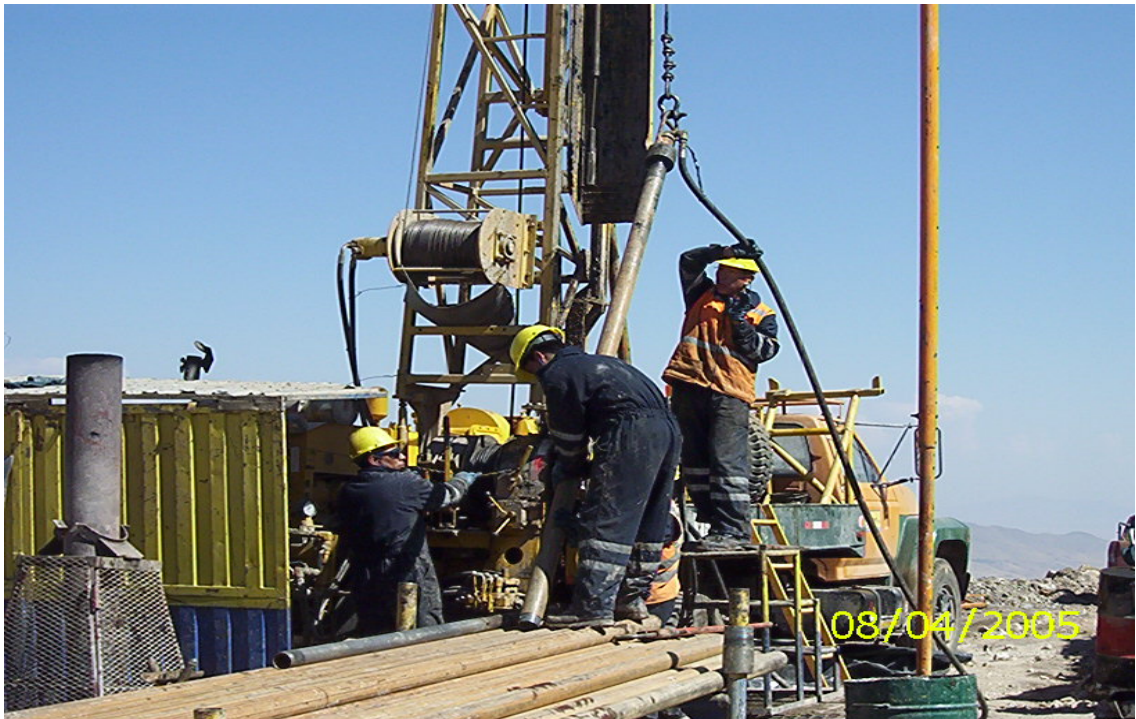
Foto 4: En la manipulación de los elementos de la perforación, se debe usar los EPP completos y de manera obligatoria.
