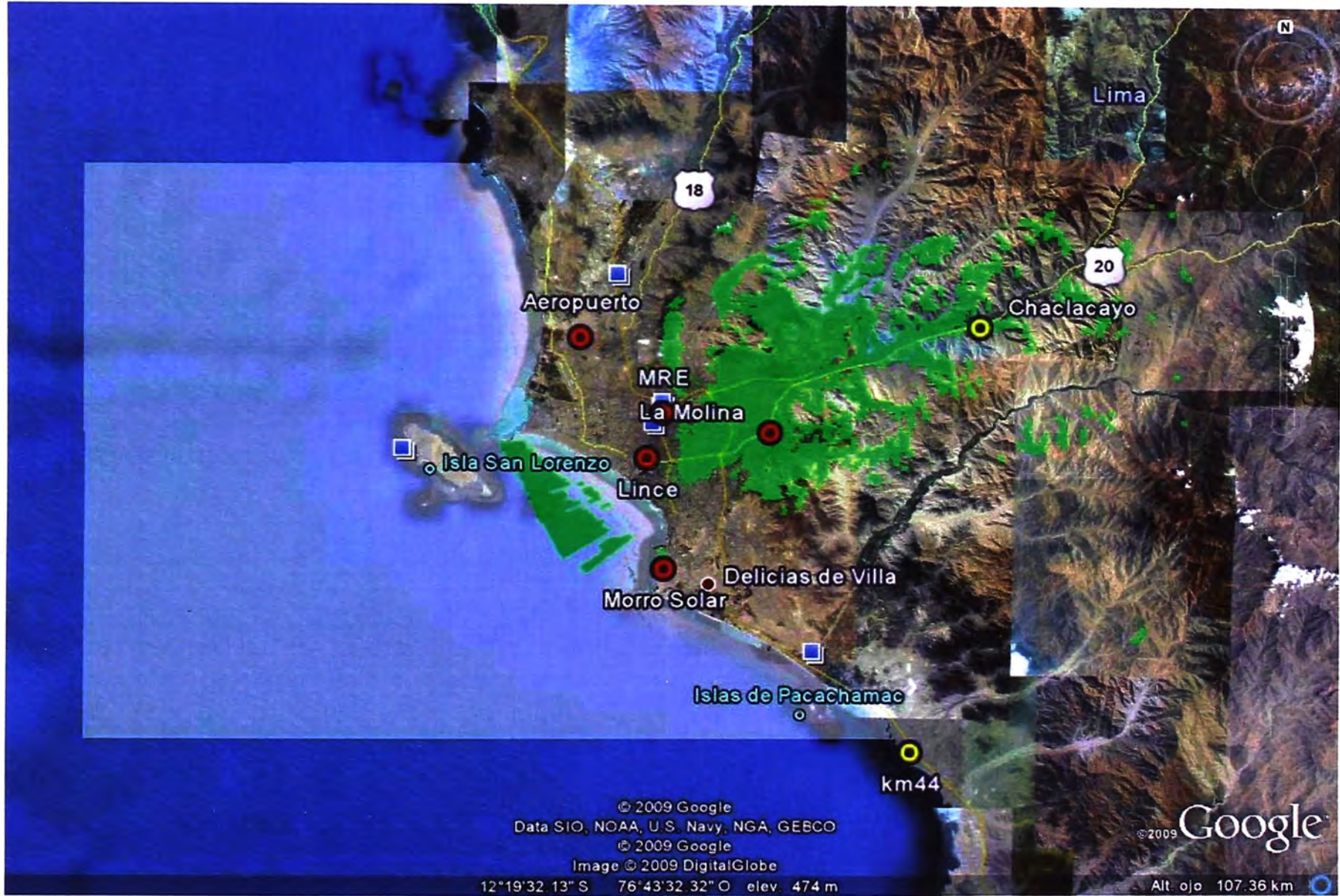
Figura C.3 Cobertura para la estación repetidora "La Molina"
