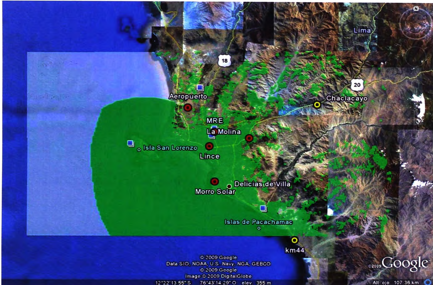
Figura C.6 Cobertura para la estación repetidora “Morro Solar”
