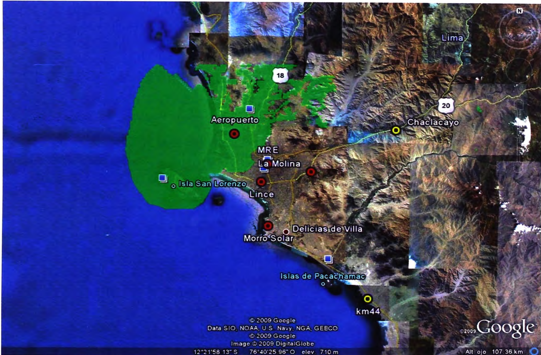
Figura C.5 Cobertura para la estación repetidora "Aeropuerto"
