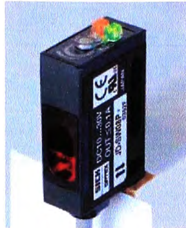
Figura 3.21 El sensor de barrera JT-H(S)1000NR (NPN).
