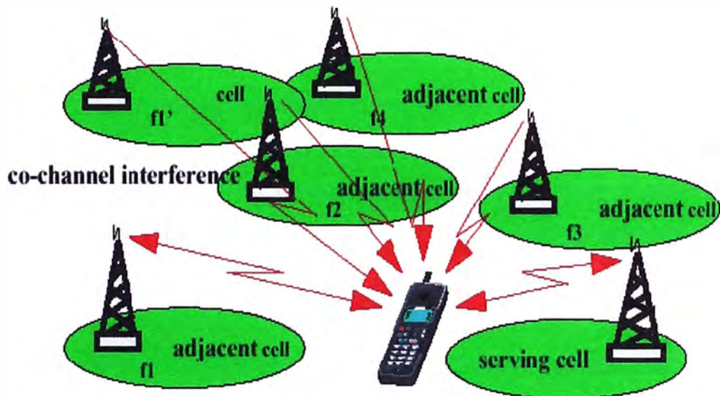
Figura 9. Esquema del procedimiento de Hard handover
