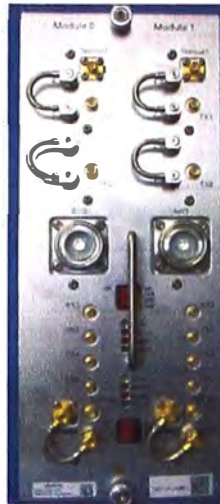
Figura 25. Módulos de BTS (ECU, FCU y FDUAMCO)
