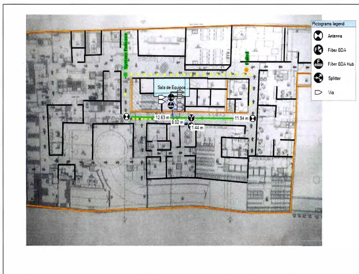
Figura 3.17 Ubicación de antenas y equipos en Subsuelos 1, 2,3 y Entre Piso (Fuente Propia).
