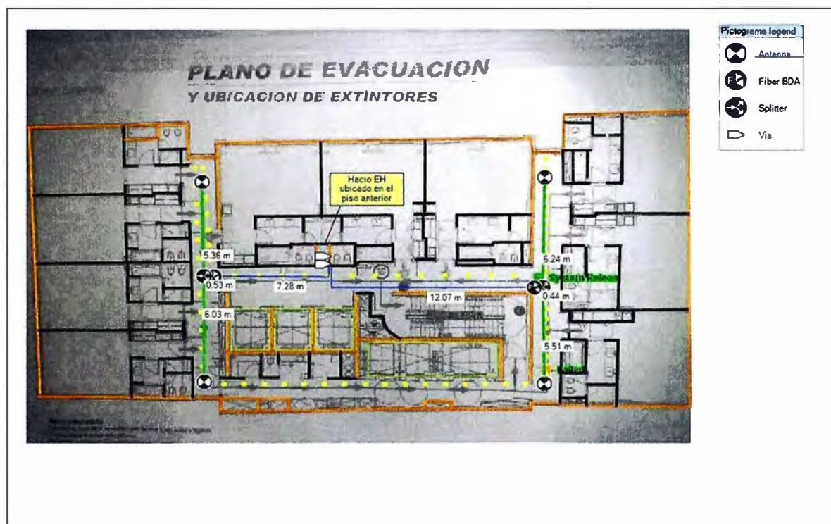
Figura 3.18 Ubicación de antenas y equipos en los pisos 2 al 13 (Fuente Propia).
