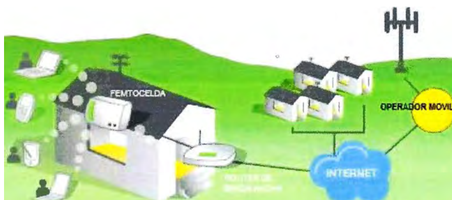
Figura. 3.1 Ejemplo de arquitectura femtoceldas. (Ref. [8])
