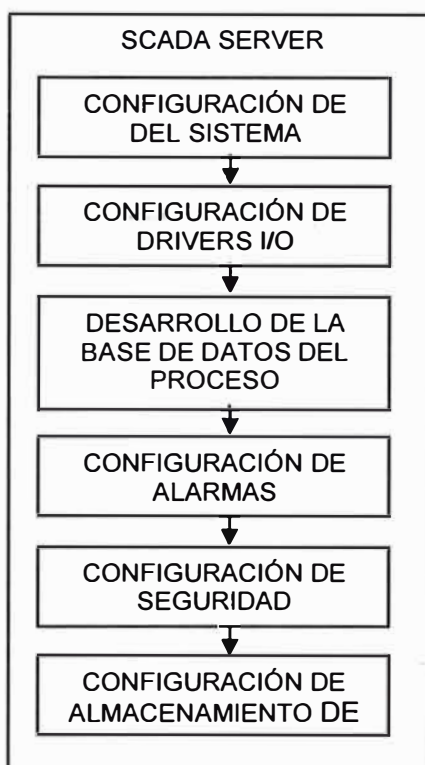
Figura 2.10 Diagrama de Bloques del desarrollo de un sistema SCADA
