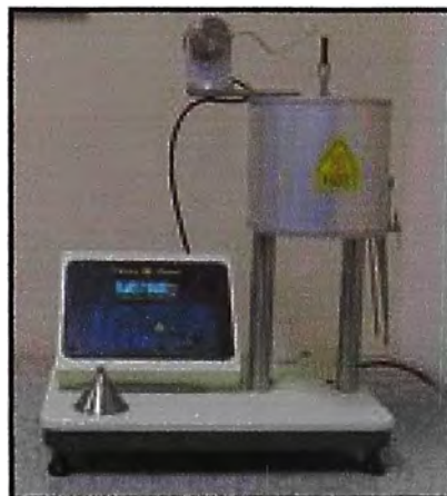
Fig. N° 13 El instrumento denominado Plastómetro
