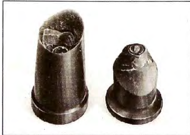
Fig. 4.33: Aislador 20 kV 400 Kg fracturado por carga de torsión de 3250 Kg/cm.
