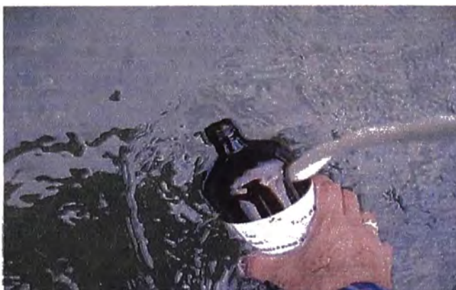
Fig. N°4.1. Toma de muestra de efluente de la planta de tintorería.
