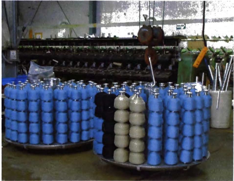
Fig. N° 3.10. Secadora convencional de portamateriales de dos árboles, para bobina de hilo.
