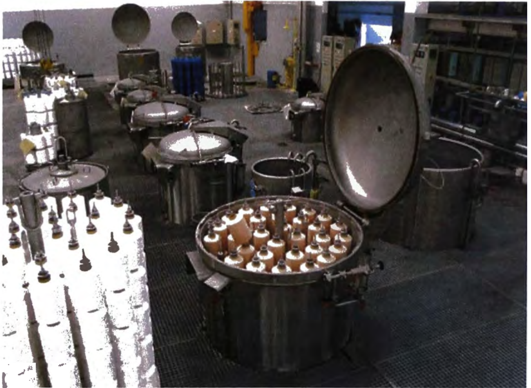
Fig. N° 3.6. Planta de Tintorería. Se muestran las maquinas de autoclave para teñido de hilo en bobina.
