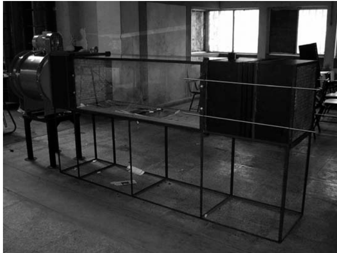
Figura 4.21: Túnel de viento en construcción Fuente: Elaboración propia.
