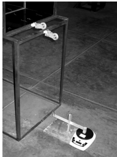
Figura 4.16: Arreglo de balanza y palanca para medición de la fuerza de arrastre Fuente: Elaboración propia.
