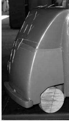
Figura 4.28: Cobertor aerodinámico frontal Fuente: Elaboración propia.
