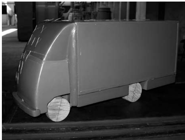
Figura 4.31: Modelo a escala con cobertores aerodinámicos
