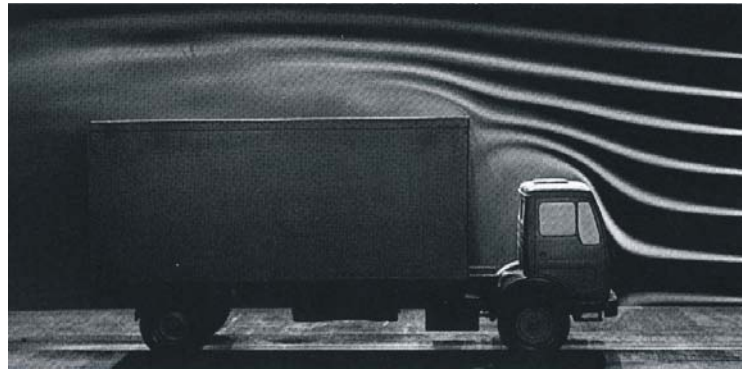
Figura 2.27: Visualización del patrón de flujos Fuente: H. Hucho, "Aerodynamic of Road Vehicles", 1987.
