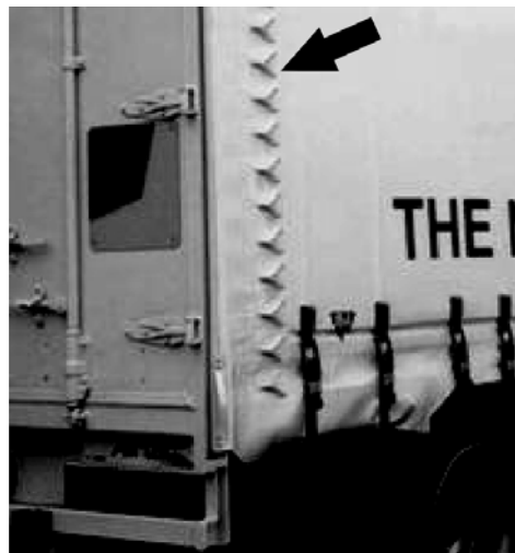
Figura 2.41: Instalación de generadores de vórtices
