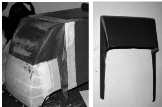
Figura 4.27: Elaboración del cobertor aerodinámico Fuente: Elaboración propia.
