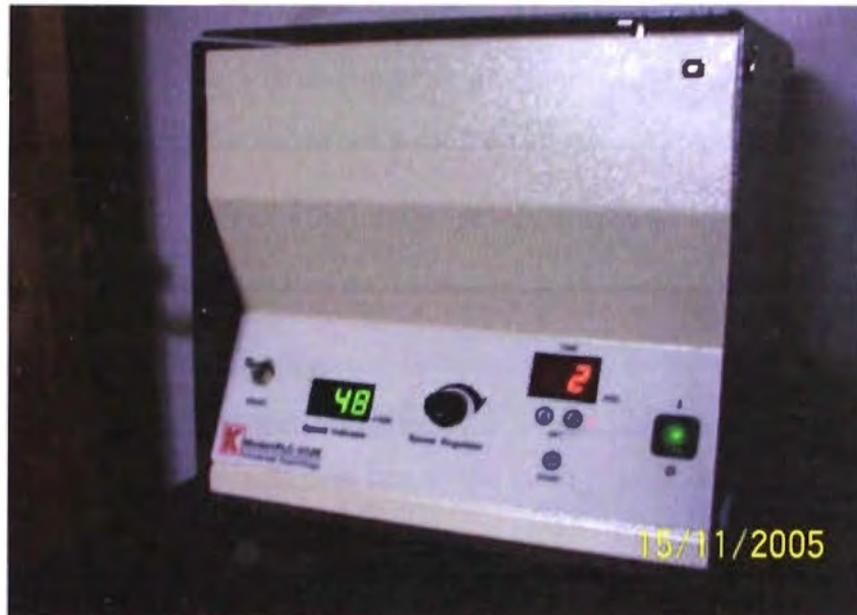
**Figura 26** Centrifuga usada para la clarificación del extracto.
