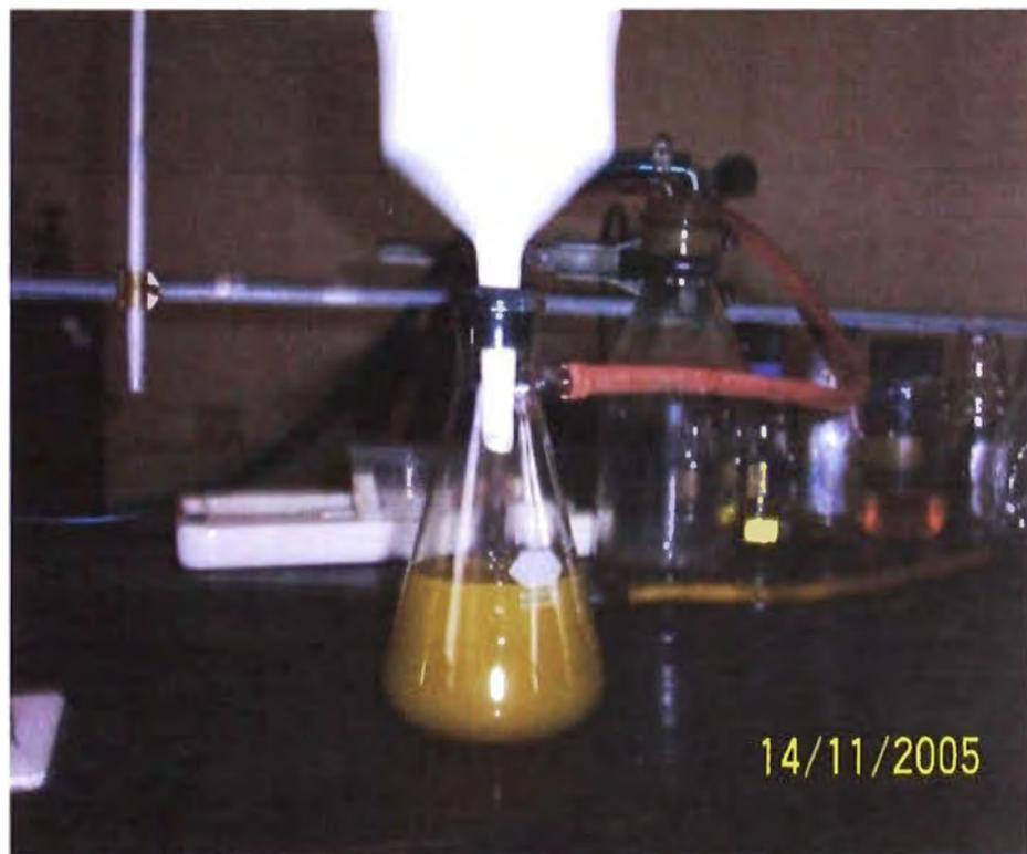
**Figura 25** Filtración del extracto al vacío.
