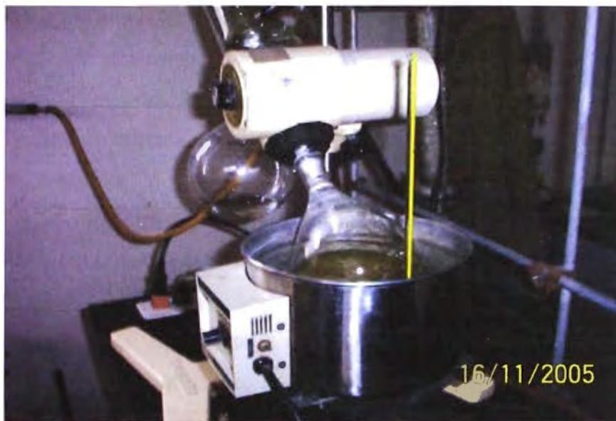
**Figura 28 Rotavapor, equipo utilizado para la concentración del extracto.**
