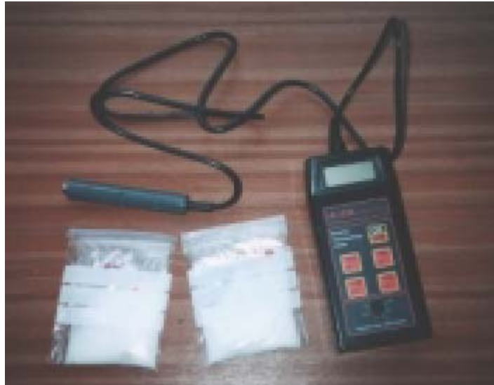
Medidor portátil de conductividad y bolsas cuidadosamente pesadas de sal
