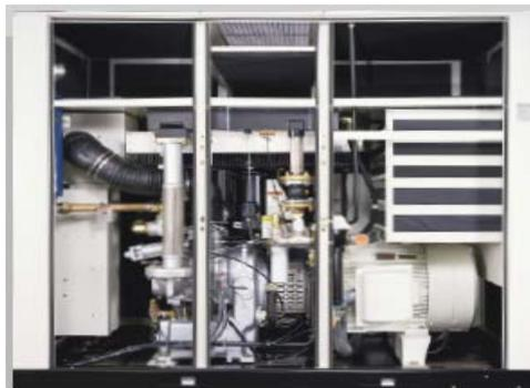
**Figura 2.9:** Compresora tipo tornillo libre de aceite enfriada con aire.
