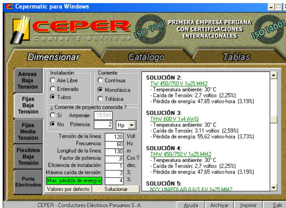
**Figura 4.10:** Cálculo del conductor de fuerza de los secadores y válvula solenoide mediante el software Cepermetic para Windows.
