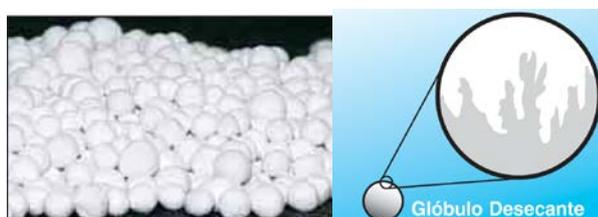
**Figura 3.4:** Desecante alúmina activada y una magnificación de una sección mostrando poros.
