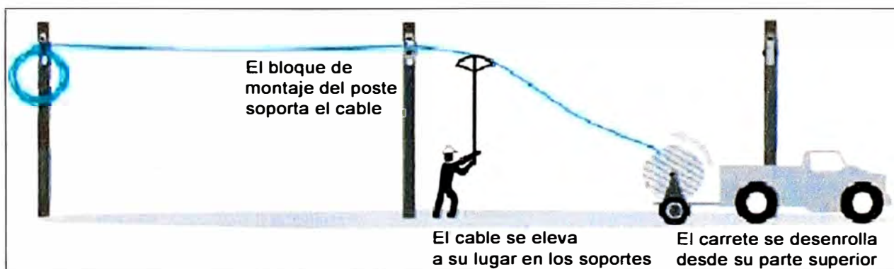
Figura 2.10 Método de tendido con desplazamiento de carrete
