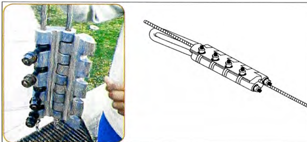
Figura 2.3 Tensor provisional y mordaza de sujeción temporal con tornillos de acero
