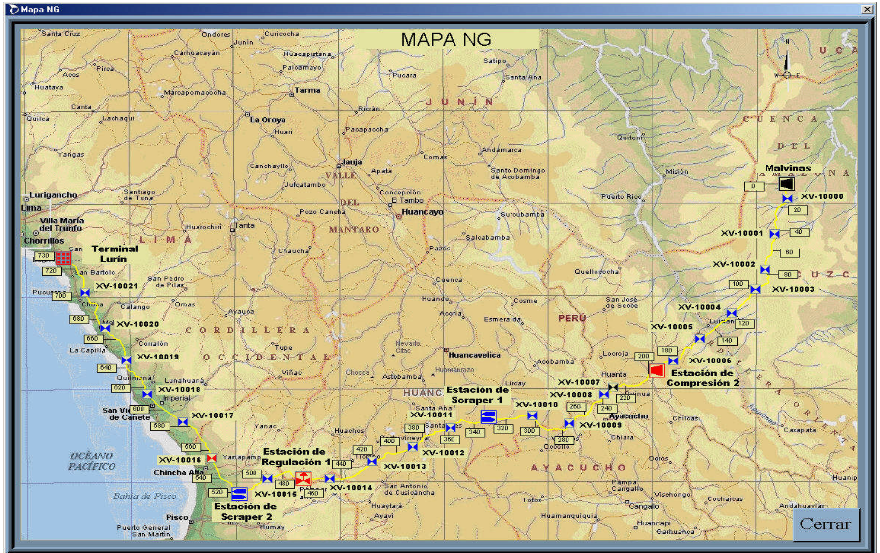
Figura 29. Línea de Gas Natural de TGP
