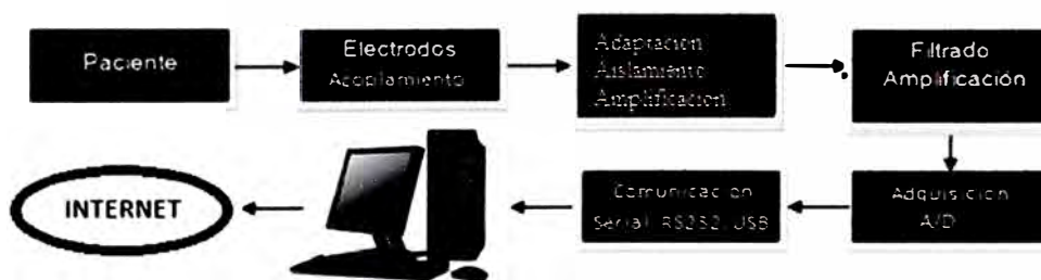
Fig. 4.1 . Diagrama de bloques de Sistema de Adquisición
