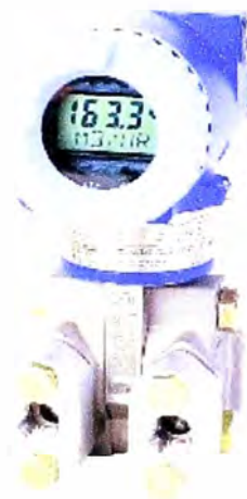
Fig. 3.12 Medidor de presión diferencial
