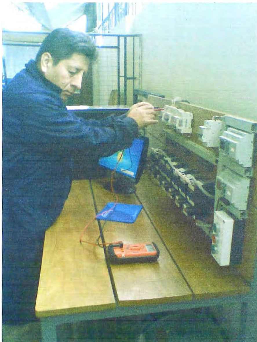
Fotografía C.3 Verificando con el voltímetro las tensiones de entrada a los circuitos de fuerza ,de mando y del PLC.
