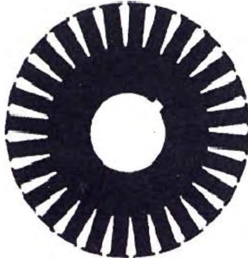
Figura 2.3 Lámina ferromagnética del rotor de un motor asíncrono tipo jaula de ardilla, de diseño de clase B[3]
