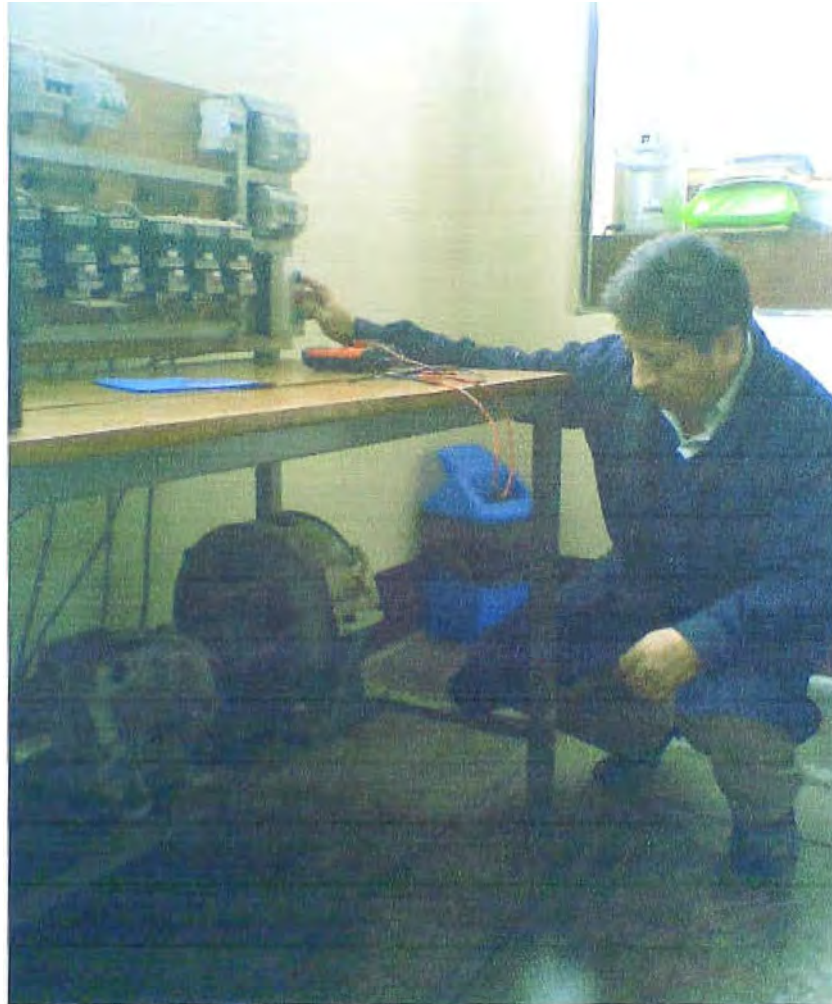
Fotografía C.6 Puesta a prueba de uno de los arranques que controla el PLC
