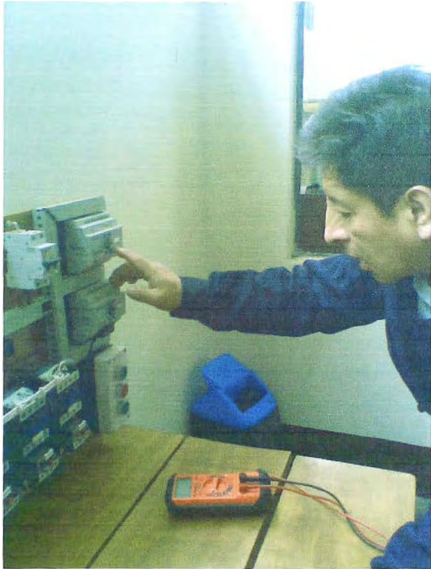
Fotografía C.5 Comprobación de los principales parámetros del PLC.
