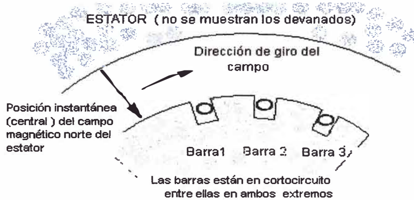
Figura 1.3a Giro del campo magnético que se presenta en el entrehierro de un motor tipo jaula de ardilla
