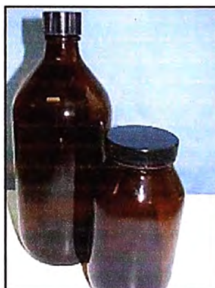
Figura 3.1: Envases recomendados para almacenamiento de muestras de aceite.
