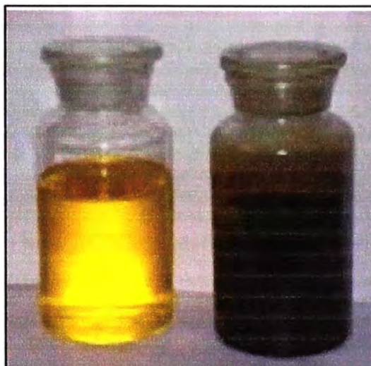
Figura 2.1: Aceite dieléctrico nuevo y luego del uso del transformador
