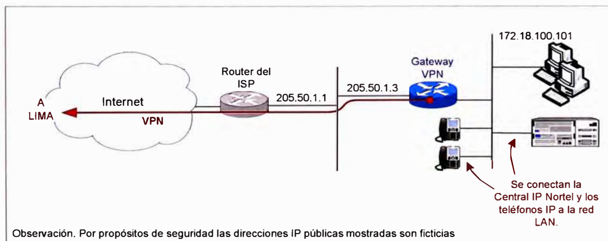
Figura 3.7 Modo de conexión de canales de voz en Alicorp
