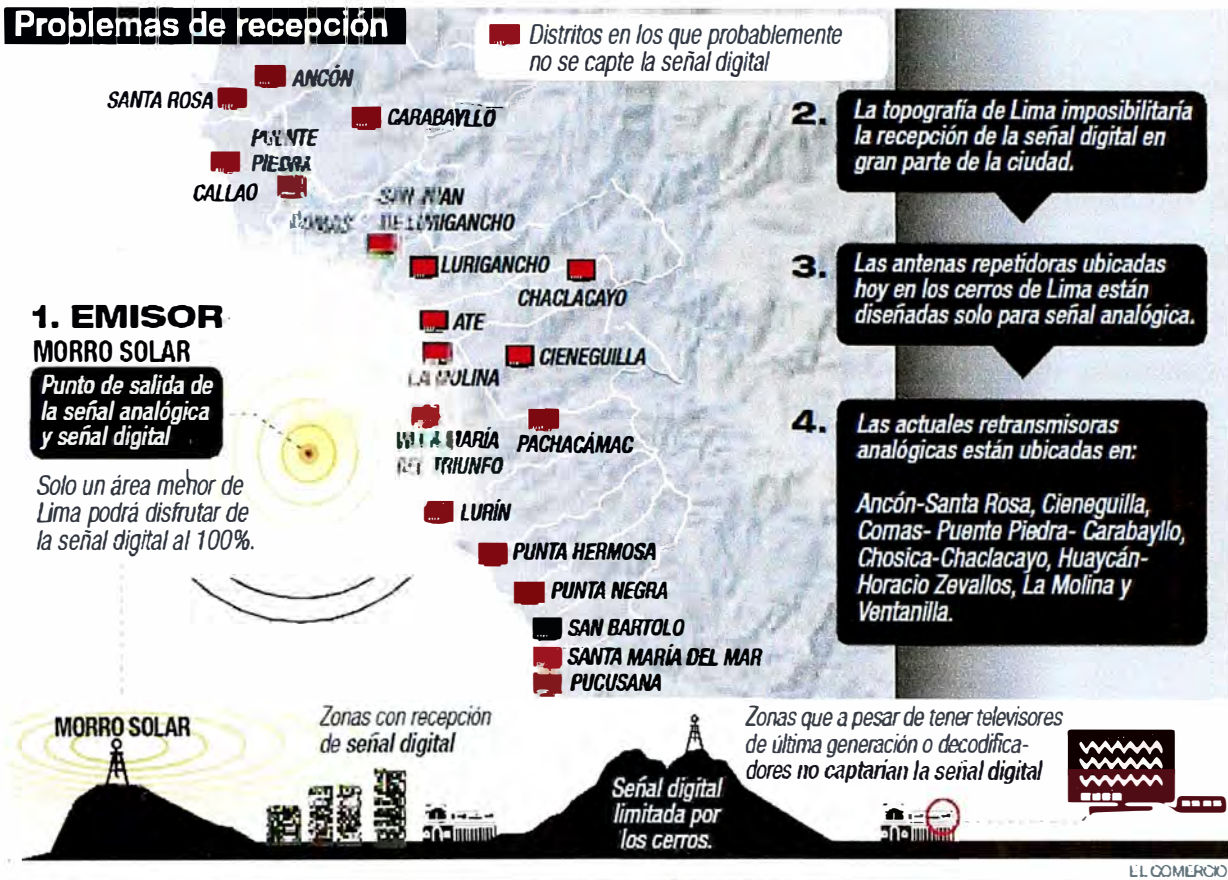
Figura 2.21 Cobertura de la señal de la televisión digital terrestre (Fuente El Comercio)
