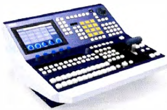
Figura 3.4 Switcher de Producción en Multi-formato HDTTS-1500
