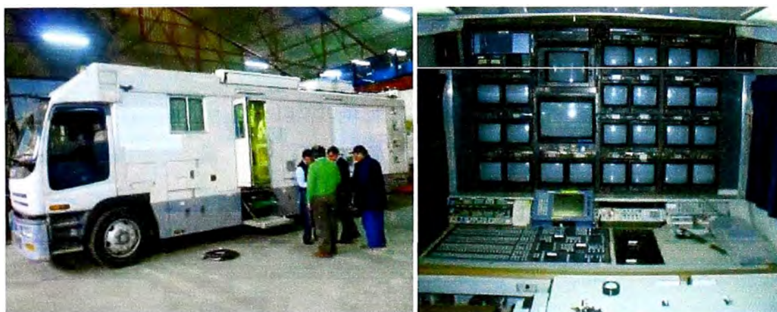
Figura 4.1 Unidad Móvil HD para la transmisión desde el lugar de los hechos.
