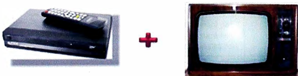
Figura 2.4 Set Top Box para la recepción de la señal de TDT en un televisor común
