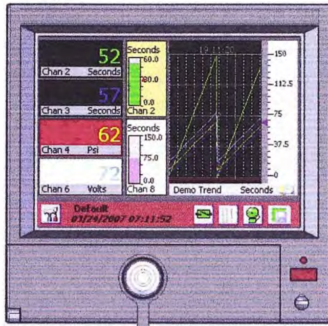
FIG. 2.5, Cuantificación y visualización de las señales que ingresan por los puertos de la tarjeta acondicionadora de señal, por los diferentes canales (en esta imagen se aprecia la presión, el tiempo y voltaje), Fuente: Manual Datachart 6000, fabricante: Monarch Instrument [11].
