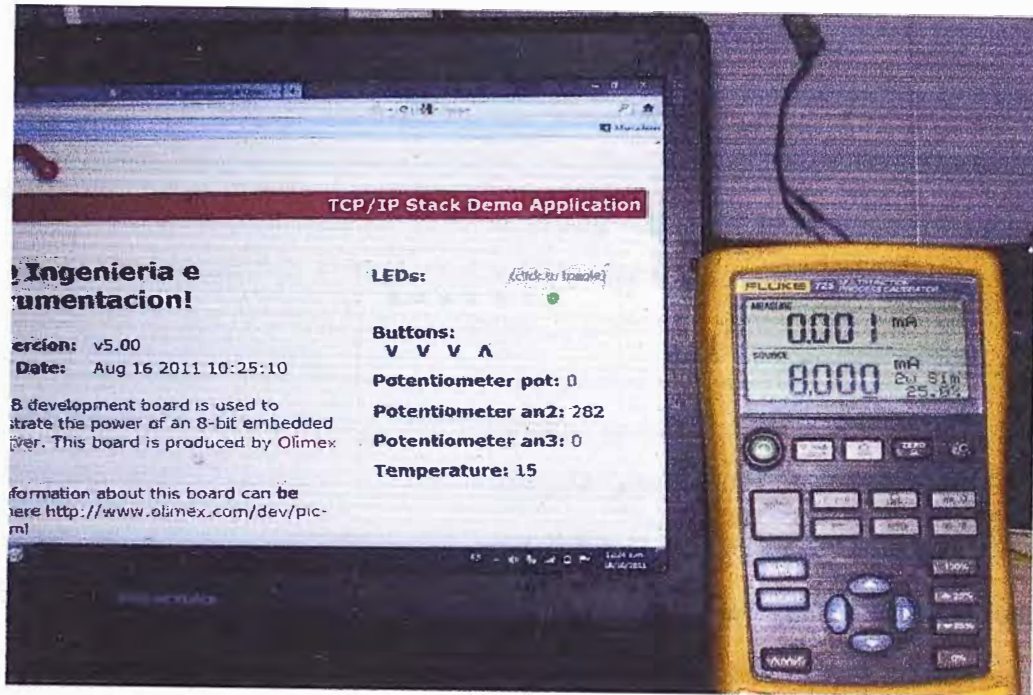
FIG 4.5, Pruebas de entrada analógica “AN2”, Fuente: Archivos del proyecto, Compañía “C y Q Ingeniería e Instrumentación S.A.C.”
