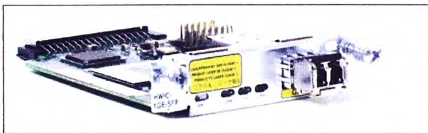
Figura 3.11 Cisco Gigabit Ethernet HWIC con modulo SFP
