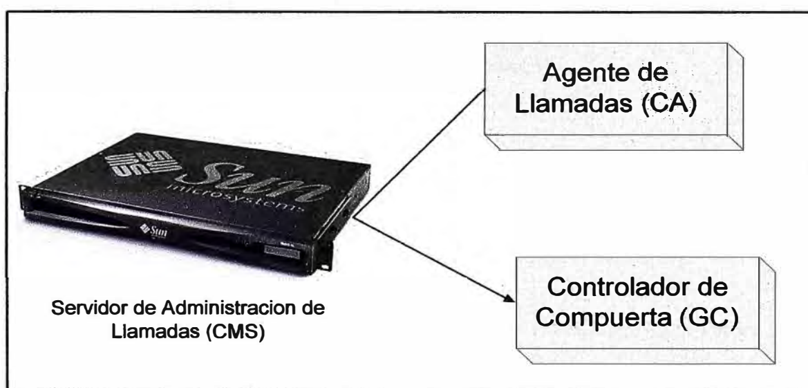
Figura 2.9 Servidor de Administración de Llamadas en PacketCable
