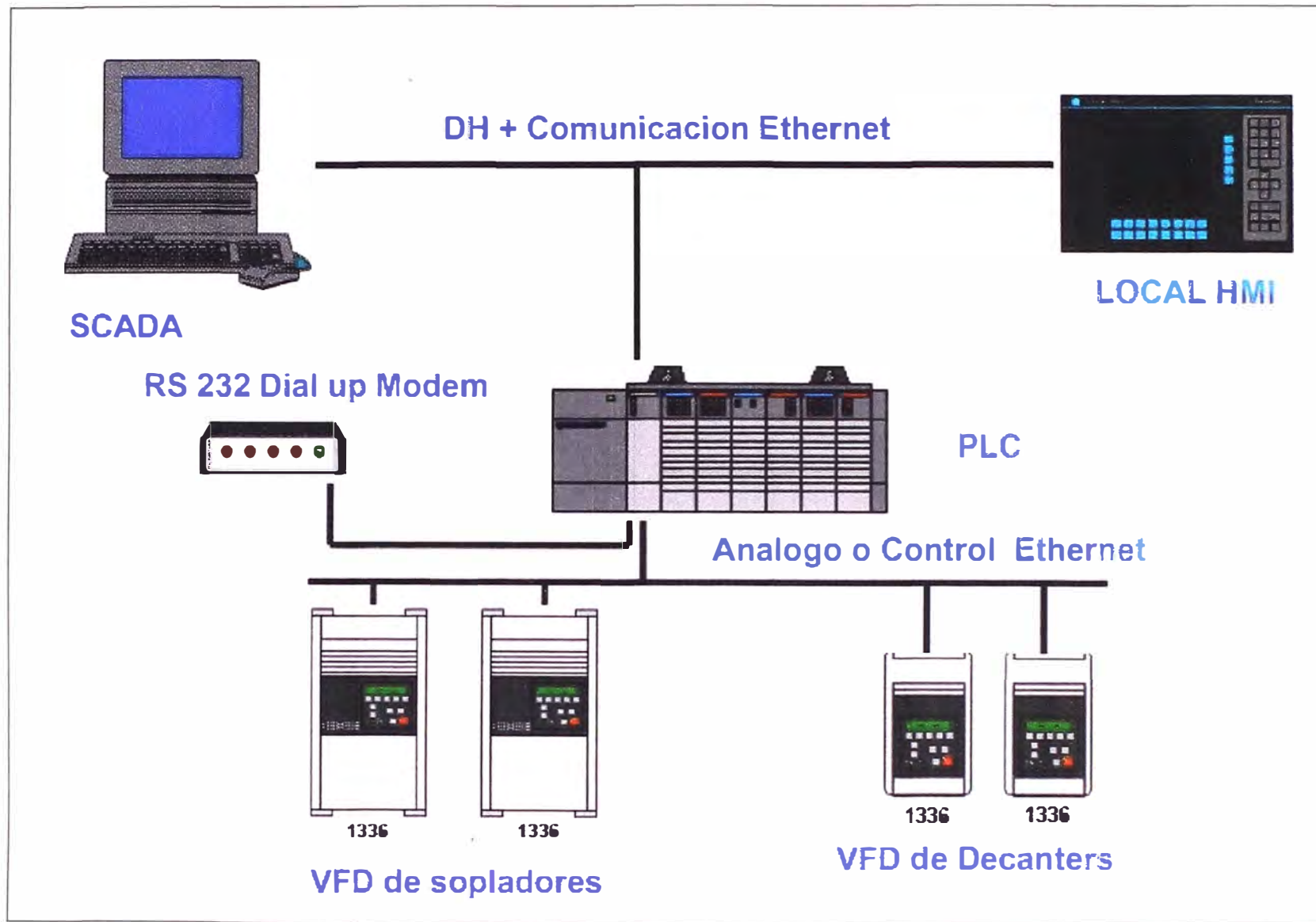
Figura 3.9 Sistema de Control y Comunicación
