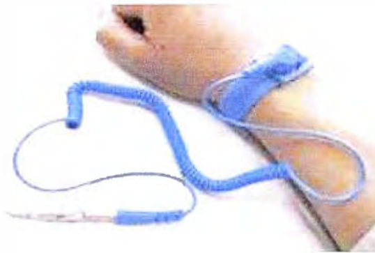
Figura .3.14. Uso de pulsera antiestática.
